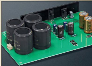
VERSORGEN: Stromversorgungsplatte mit vier Sieb-Elkos à 15000 µF.
